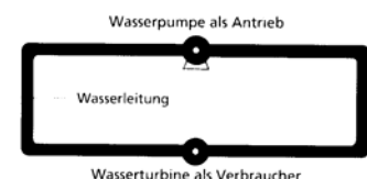
2 Wassermodell für einen einfachen Stromkreis
